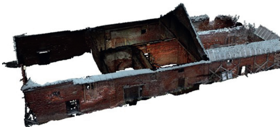
Рис. 2. Единая модель амбара в виде плотного облака точек
