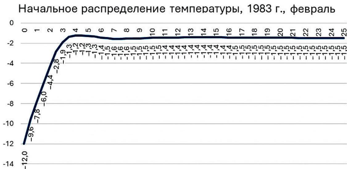
Рис. 3. Температура в термометрической скважине в феврале 1983 г.
