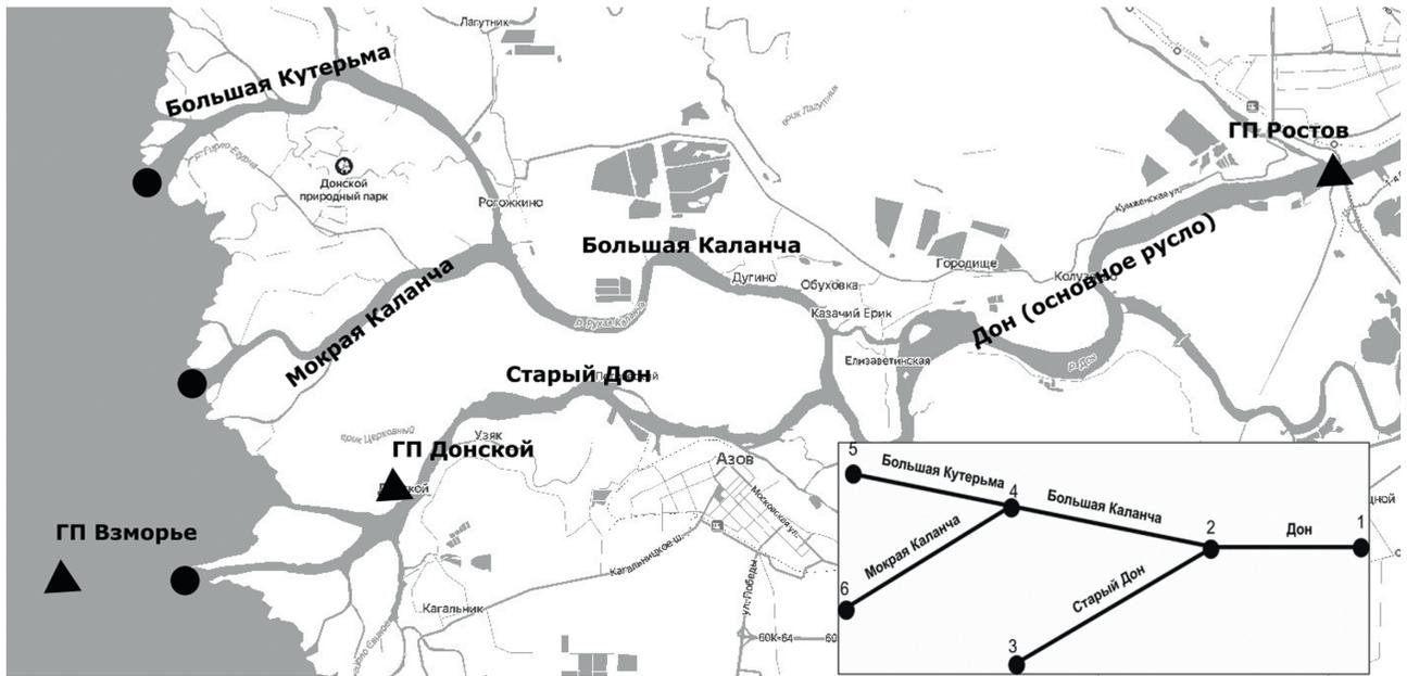
Рис. 1. Расположение гидропостов и расчетных точек уровней в устьях основных рукавов Дона: *кружками* обозначены точки, соответствующие устьям рукавов; *треугольниками* – гидропосты, где наблюдались уровни воды; *на врезке* – схема устьевой области
