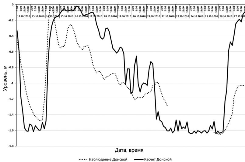
Рис. 3. Сравнение наблюдаемых и расчетных колебаний уровня воды на ГП в Донском (период с 12.10.2016 по 27.10.2016)
